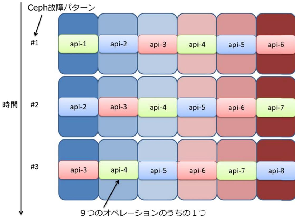
上記の図は、7システムのうち6システムを使用して、6個のテスト項目を並行に実施する様子を表しています。
