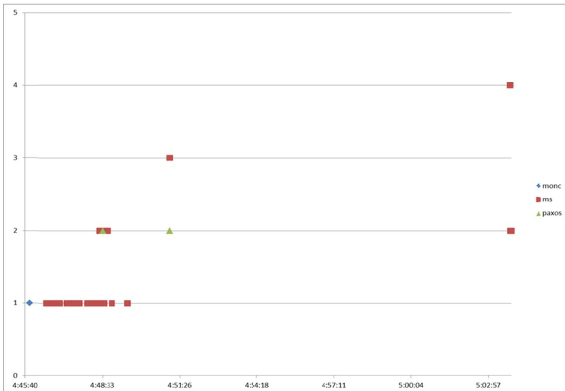
上記の図は、テスト項目 #1 の通常の状態ログレベル分布を比較して抽出された、テスト項目 #34 でのみ出力されていたログの時系列での件数分布です。
