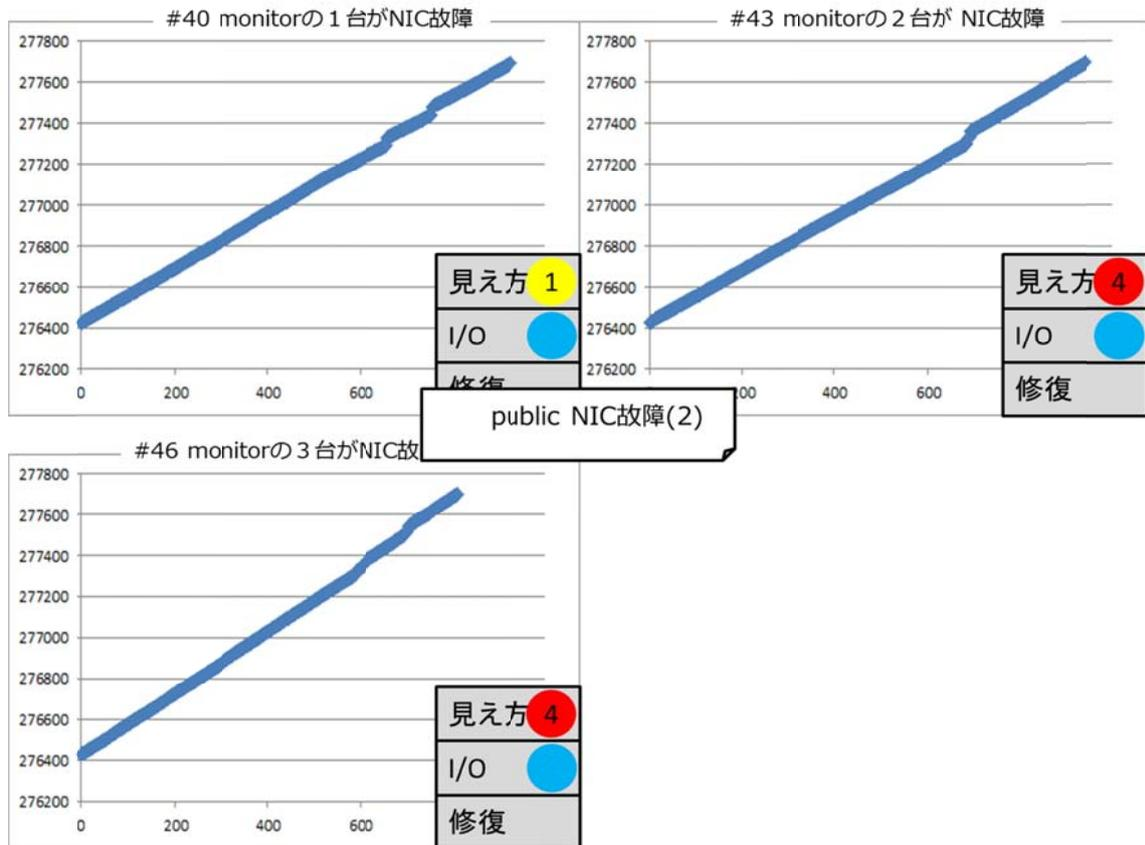
Ceph MON がダウンする項目と同様に、Ceph MON の 2 台または 3 台全てで NIC 故障が発生している間も I/O が継続されていたことがわかります。テスト項目 #40 はコマンド (ceph -watch) 出力上、Ceph MON の NIC 故障は Ceph MON のダウンとして見えています。また、テスト項目 #43 と #46 は Ceph MON クラスタが定足数に満たない状況のため、コマンド (ceph -watch) の出力から Ceph MON の NIC が故障していることが判別できません。
