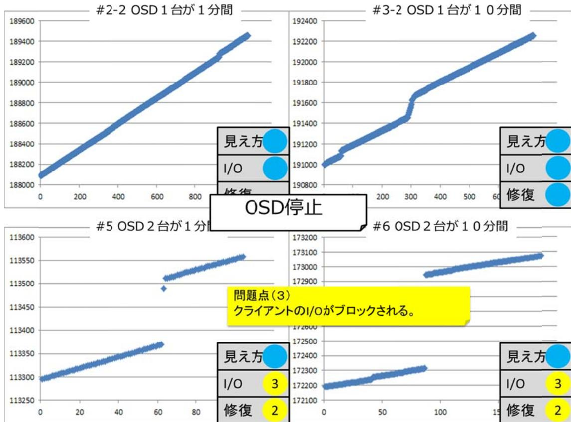
グラフを確認すると、サーバーダウン中、テスト項目 #2-2 と #3-2 では I/O が継続されていたこと、テスト項目 #5 と #6 では I/O がブロックされていたことが分かります。テスト項目 #5 と #6 の I/O プロセスはいずれも終了していないので、ダウンしたサーバーが復旧した時点で I/O のブロックが解け、I/O エラーは発生していないことが分かります。サーバーダウン中、テスト項目 #3-2 では I/O の進捗が遅くなっていたようです。これは、サーバーダウン中にデータ冗長度の修復処理が動作した影響の I/O 性能劣化とされます。テスト項目 #2-2 で I/O 性能劣化が見られないのは、サーバーダウンの状態が持続する時間 (1 分以上) が短く、データ冗長度の修復処理が開始される前にダウンしたサーバーが復旧したためとされます。
