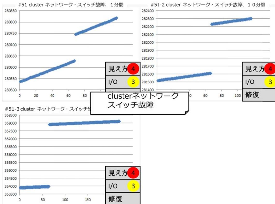
いずれのテスト項目も cluster network のスイッチがダウンしている間 I/O がブロックされていたことが分かります。I/O プロセスはいずれも終了していないので、cluster network のスイッチが復旧した時点で I/O のブロックが解け、I/O エラーは発生していないことが分かります。cluster network は、Ceph OSD 間の通信に使用されます。Ceph クライアントからのオブジェクト書き出しの I/O 要求は、CRUSH アルゴリズムで決まるプライマリ OSD が受信し、プライマリ OSD が CRUSH アルゴリズムで決まるレプリカ OSD に I/O 要求を配布し、レプリカ OSD からの応答を回収してから Ceph クライアントに応答します。よって、プライマリ OSD とレプリカ OSD の間の通信ができない状況のため、Ceph クライアントの I/O 要求の応答がなかったものと思われます。
