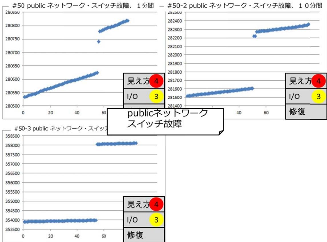
いずれのテスト項目も public network のスイッチがダウンしている間 I/O がブロックされていたことが分かります。I/O プロセスはいずれも終了していないので、public network のスイッチが復旧した時点で I/O のブロックが解け、I/O エラーは発生していないことが分かります。public network のダウンはコマンド (ceph -watch) と Ceph MON クラスターの通信もできないため、コマンド (ceph -watch) 出力から public network がダウンしたことを判別することはできません。
