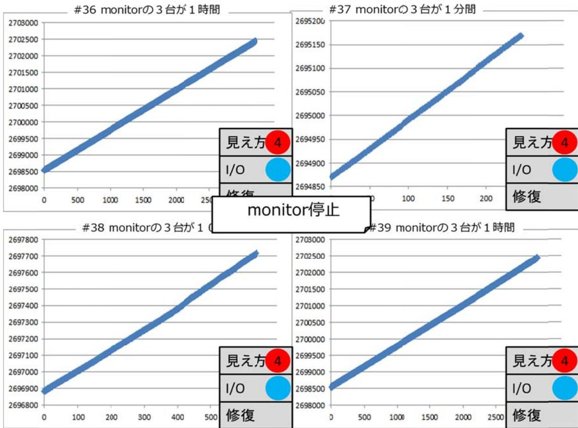
テスト項目 #32-2 から #35 と同様に #36 から #39 についても Ceph MON の 2 台または 3 台全てでダウンが発生している間も I/O が継続されていたことがわかります。いずれのテスト項目も、Ceph MON クラスタが定足数に満たない状況のため、コマンド (ceph -watch) の出力から Ceph MON がダウンしていることが判別できません。
