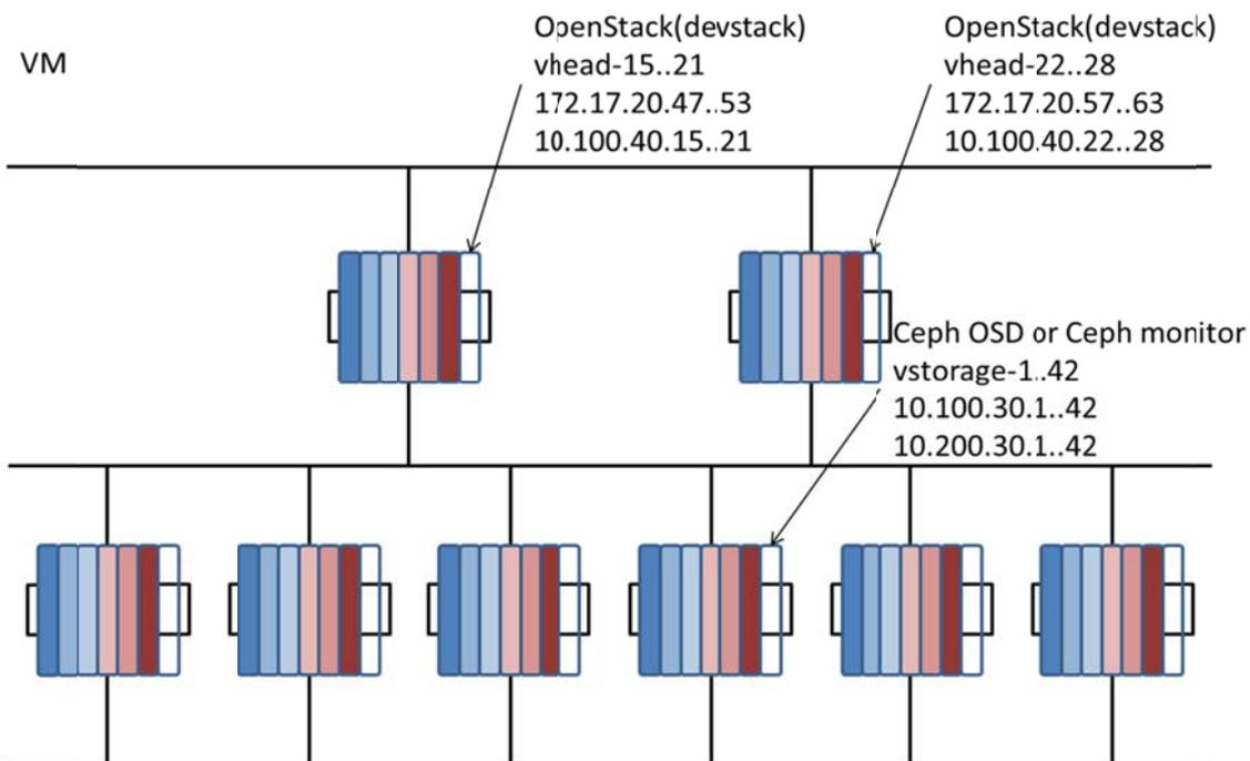
上記の図は、物理的サーバーの構成と、その上に VM で構成した 7 つのシステムを表しています。
