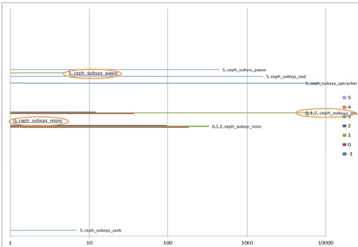
上記の図は、OpenStack/Ceph 異常系テストのテスト項目 (故障パターン) のうち、テスト項目 #1 の通常の状態と、テスト項目 #34 の 3 台中 2 台の Ceph MON でダウンが発生した場合でのログレベル分布を比較した例です。丸で囲ったサブシステムとログレベルのログがテスト項目 #34 でのみ出力されていたことを表します。
