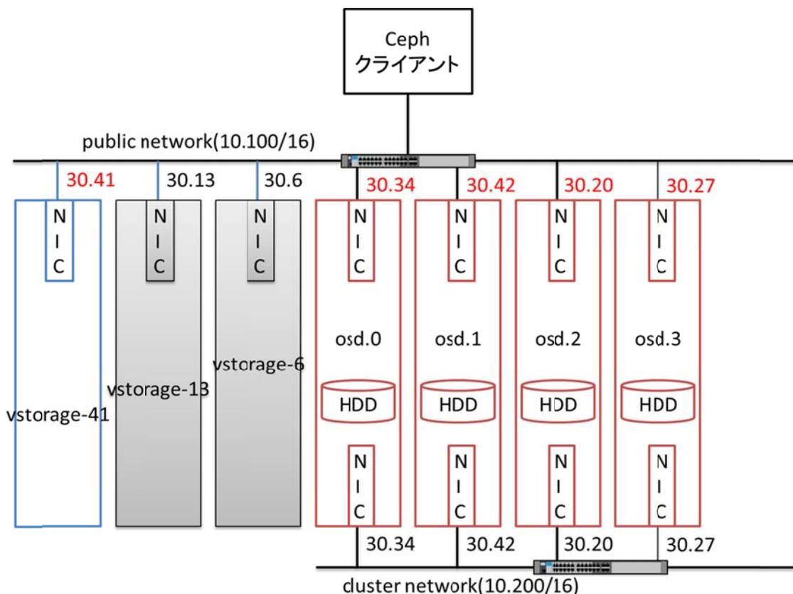
上記の図は、テスト項目 #34 でダウンさせた Ceph MON 2 台を灰色で示し、テスト項目 #1 の通常の状態のログレベル分布を比較してテスト項目 #34 でのみ出力されていたログにある通信失敗の箇所を赤字で示しています。つまり、テスト項目 #34 の実施によって検出された、コマンド (ceph -watch) で現象 (3 台中 2 台の Ceph MON ダウン) を検知できない問題に対する代替手段として、故障パターンに特徴的なログの内容 (通信が失敗している箇所) から現象を推測する方法が確認できたと思います。
