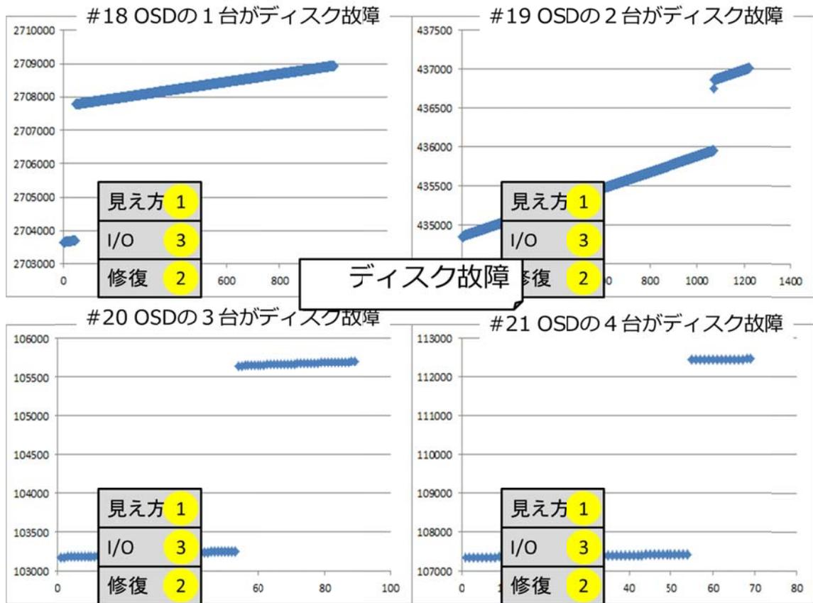
テスト項目 #18 から #21 ではディスク故障中 I/O がブロックされていたことが分かります。I/O プロセスはいずれも終了していないので、ディスクが故障したサーバーが復旧した時点で I/O のブロックが解け、I/O エラーは発生していないことが分かります。
