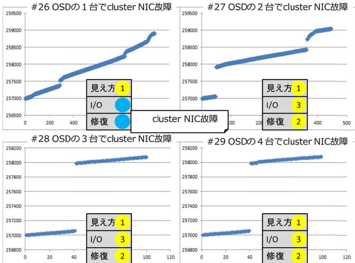
テスト項目 #27 から #29 では NIC 故障中 I/O がブロックされていたことが分かります。I/O プロセスはいずれも終了していないので、NIC が故障したサーバーが復旧した時点で I/O のブロックが解け、I/O エラーは発生していないことが分かります。
