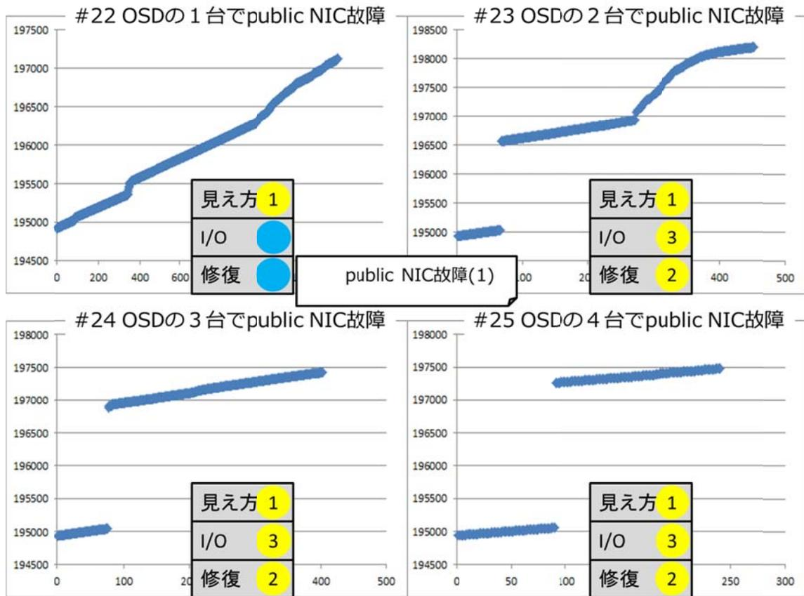
テスト項目 #23 から #25 では NIC 故障中 I/O がブロックされていたことが分かります。I/O プロセスはいずれも終了していないので、NIC が故障したサーバーが復旧した時点で I/O のブロックが解け、I/O エラーは発生していないことが分かります。
