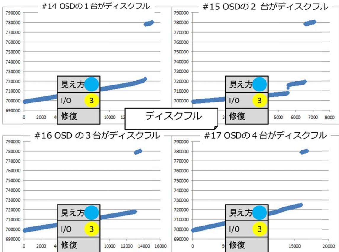
グラフを確認すると、テスト項目 #14 から #17 は I/O がブロックされていたことが分かります。I/O プロセスはいずれも終了していないので、ディスクフルが解消した時点で I/O のブロックが解け、I/O エラーは発生していないことが分かります。
