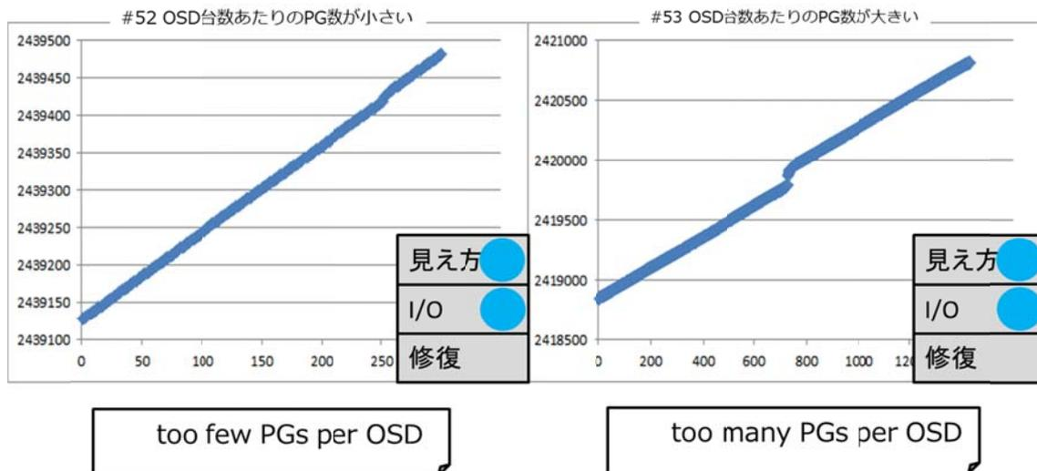
いずれのテスト項目もワーニングメッセージが出力されている間も I/O が継続されていたことが分かります。テスト項目 #53 で I/O の進捗が滞っている箇所が見られますが、これは Ceph OSD の1台で意図しないディスク故障が発生し、Ceph OSD デーモンが EIO エラーにより再起動を繰り返していたためで、本テスト項目との関係はありません。当該 Ceph OSD の対処を行うことで現象が収束することを確認しています。
