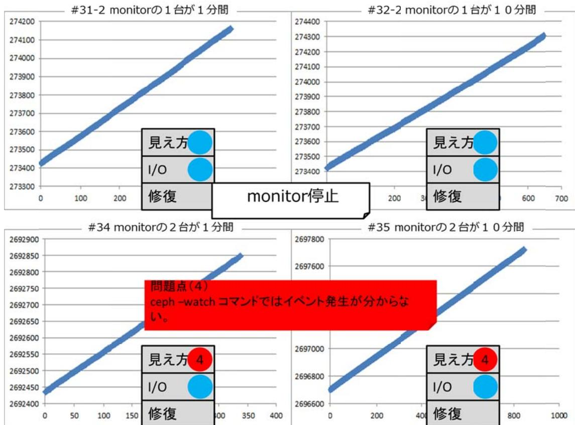
テスト項目 #32-2 から #35 では Ceph MON の 1 台または 2 台でダウンが発生している間も I/O が継続されていたことがわかります。ただし、テスト項目 #34 と #35 では、コマンド (ceph -watch) の出力から Ceph MON がダウンしていることが判別できませんでした。具体的には、2 台の Ceph MON がダウンしたにも関わらず、コマンド (ceph -watch) の出力上では、1 台の Ceph MON が停止し HEALTH\_WARN に状態遷移し、当該 Ceph MON 再起動後に HEALTH\_OK に状態したように見え、もう 1 台の Ceph MON が停止したことがわかりませんでした。
