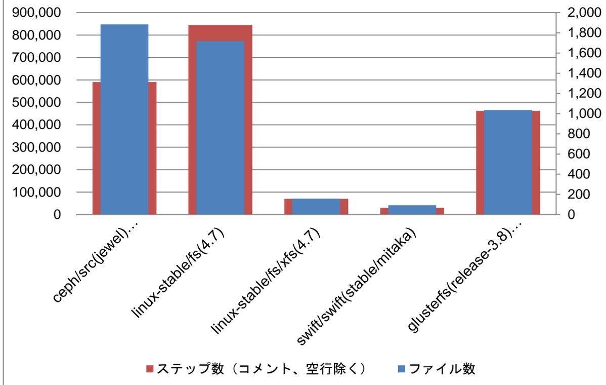
テストコードや内部的に使用している Ceph 以外のコンポーネント（キーバリュースタアやウェブサーバー等）を除いたコード全体の規模は Linux カーネルに含まれるすべてのファイルシステムのコード (linux-4.7/fs) の総量におよそ匹敵します。
